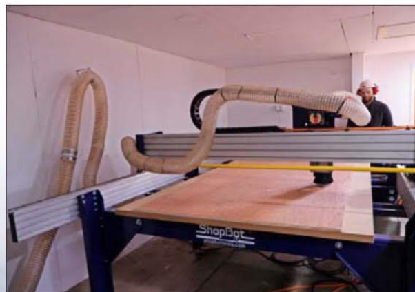
Los equipos son los mismos en todos los Fab lab del mundo y fueron donados por Fab Foundation. En la foto, una máquina CNC, que permite fabricar piezas de gran tamaño.
